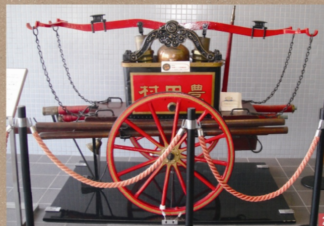
▲腕用ポンプ／両方の腕木に最低3、4人ずつ、計6人以上の人がつき、ポンプをおおって水を送り、消火します。
