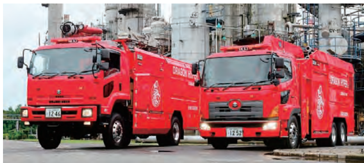
ドラゴンハイパー・コマンドユニットの中核車両である 大型放水砲車（左）と大容量送水ポンプ車（右）
