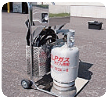
初期消火装置
