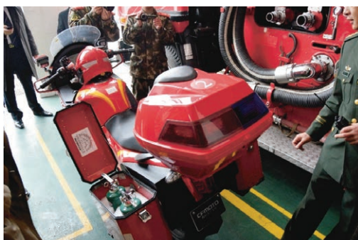
消防バイク（左右ボックスに消火器を収納）
