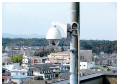
火災監視カメラ （双葉地方広域市町村圏組合消防本部提供）
