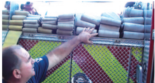
後方上部に合計120mのホース
