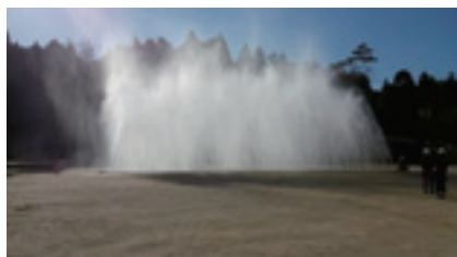
大規模密集地木造建物火災を想定したウォーターカーテン設営方法
